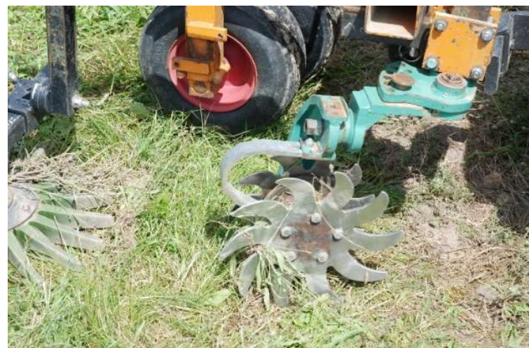
Figure 4. Outil mécanique de désherbage : le disque émotteur (Source : Cuma Occitanie)
